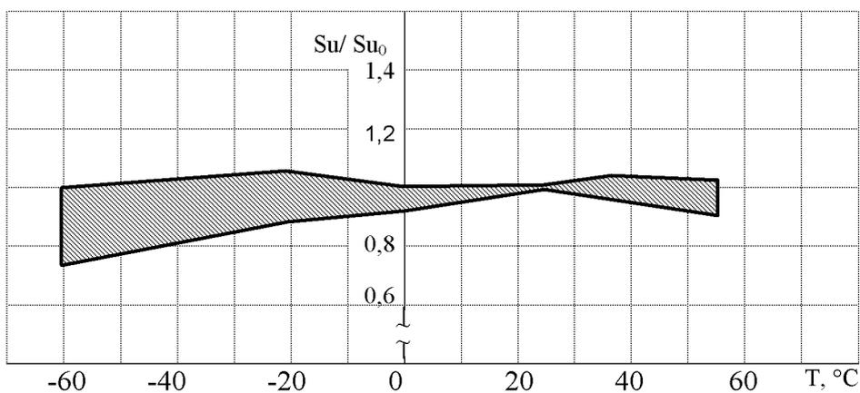
Область изменений относительного порога в единичной полосе частот от температуры окружающей среды (границы 95% разброса).
