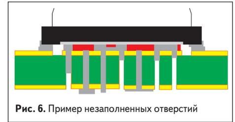
Рис. 6. Пример незаполненных отверстий
