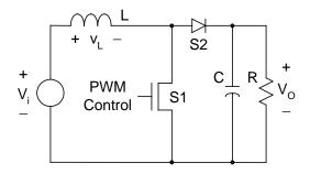
Fig. 27. The boost converter.
