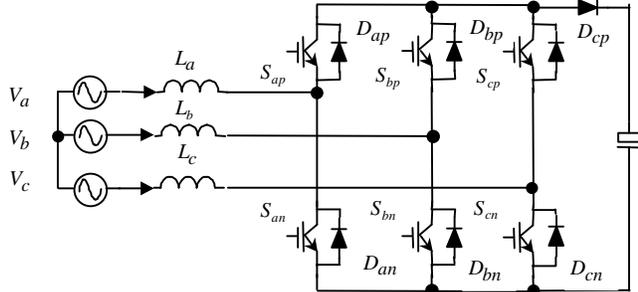
(d). 3-phase H bridge boost rectifier with a diode.
