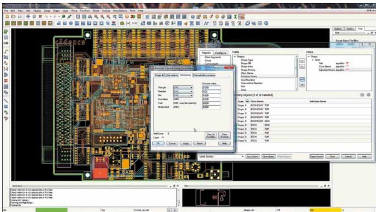
Рис. 23. Одновременное изменение свойств для нескольких найденных полигонов
