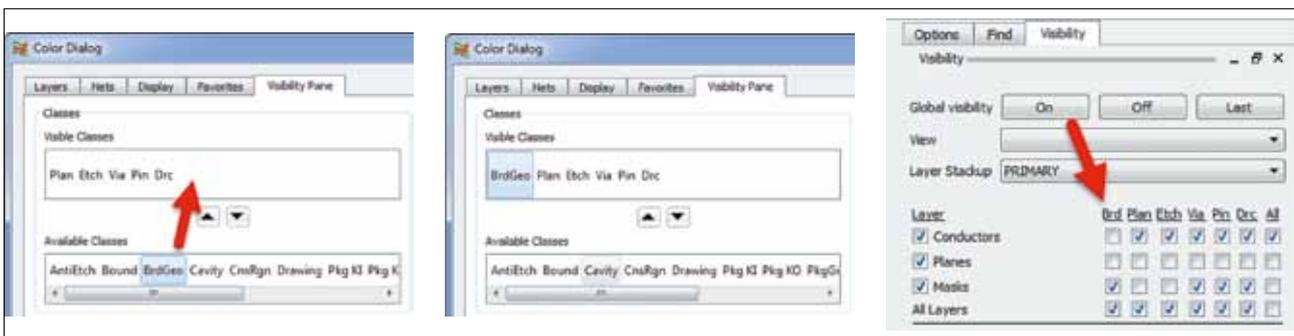
Рис. 18. Пример добавления столбца с нужными слоями в панель отображения
